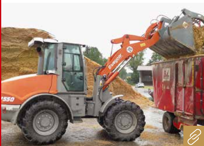
Der Radlader weycor AR 550 deckt mit seinem Dienstgewicht von 8,2 t ein vielfältiges Aufgabenspektrum ab: vom Tief- und Straßenbau über den GaLaBau bis hin zum Materialumschlag. Bild: Atlas Weyhausen
