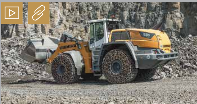
Der L 586 XPower ist mit einem Einsatzgewicht von rund 33 t der größte und schwerste Radlader aus dem Hause Liebherr. Bild: Paul Deder
