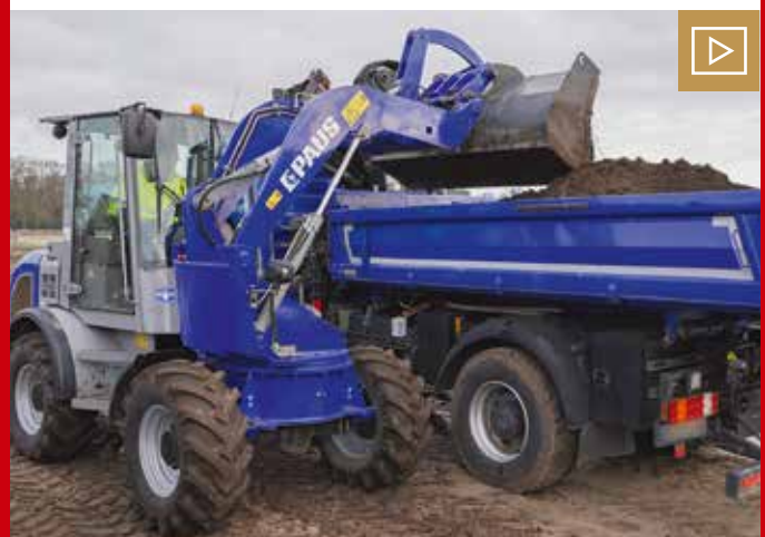
Der große Aktionsraum der Paus-Schwenklader durch die Schwenkfunktion erspart dem Bediener mehrfaches Manövrieren und minimiert den Kraftstoffverbrauch. Bild: Paus
