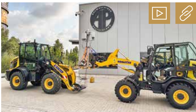
Die Maschinen lassen sich via autarkem CampusOS Netzwerk über Sitelink fernwarten. Bild: Topcon
