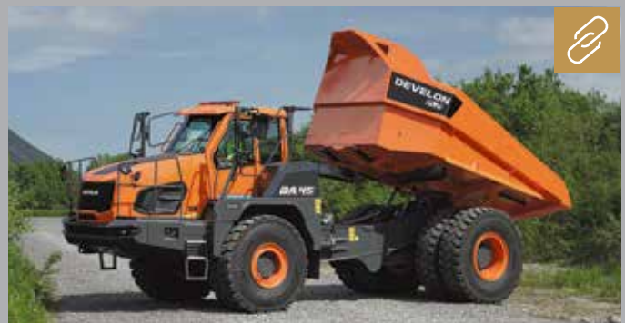
Lt. Develon schneidet der neue 4x4 ADT bei nassen und rutschigen Bedingungen besser ab als ein starrer Muldenkipper (RDT). Bild: Develon
