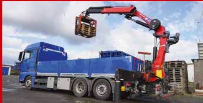
Der Ladekran 2320K von HMF kann mit Seilwinde, manueller Verlängerung und FlyJib geliefert werden. Bild: HMF Ladekrane
