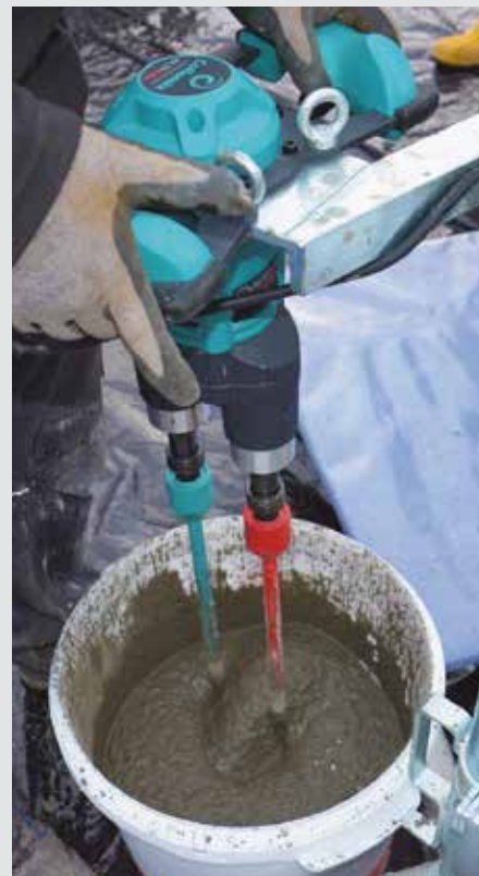
Zwei gegenläufige Rührer erzeugen einen Zwangsmischeffekt für optimale Durchmischung auch schwerster Materialien.
