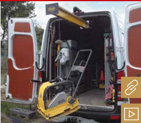
Das Onboard-Beladungssystem EasyLoad für Transporter ermöglicht es, dass schwere Lasten von nur einer Person ein- und ausgeladen werden können. Bild: MAD
