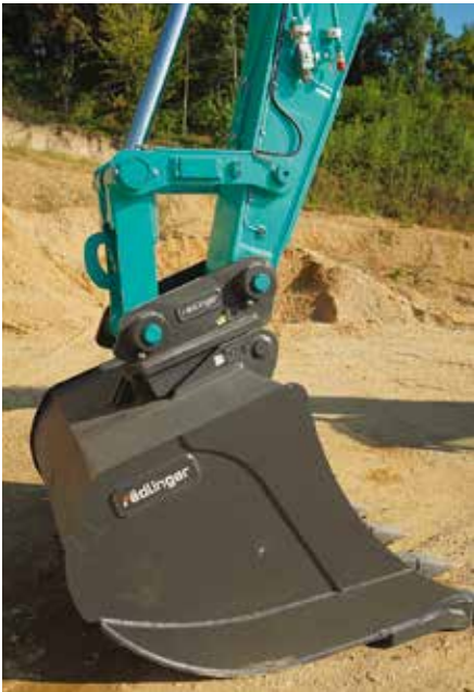
Auf Kundenwunsch rüstete EMB den 37-Tonner mit einem 2,3-m 3 -Tieföffel am mechanischen Schnellwechsler aus.
