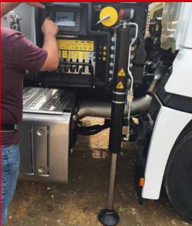
Das dynamische Belastungsdiagramm der HCK-Reihe erlaubt es dem Fahrer, die Kran-Hubkraft im Voraus auf der Grundlage der Stabilität des Fahrzeugs zu überprüfen. Bild: Hyva
