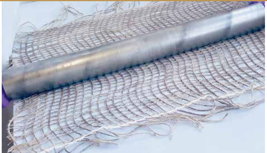
Am Fraunhofer WKI entwickelten die Forscher ein Flachsdrehergewebe mit einer biobasierten Beschichtung als Grundlage für eine Naturfaserbewehrung. Bild: Fraunhofer WKI
