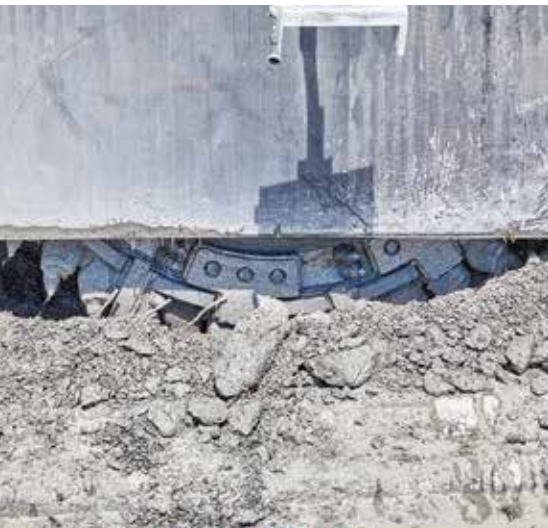
Speziell für das harte Betonfräsen wurden die Fertiger mit Sonderfräswalzen und Zusatzgewichten ausgestattet. Bild: Wirtgen
