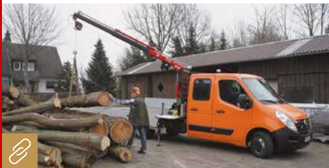
Der Maxilift 270 von Next Hydraulics mit einem Traglastmoment von 25 kNm ist vielseitig einsetzbar (hier mit Seilwinde). Bild: De Bondt
