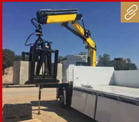
Bei der HCK-Reihe von Hyva handelt es sich um kurze Gelenkarmkräne mit doppelter Anlenkung, die auf Lastern mit kompaktem Radstand installiert werden. Bild: Hyva
