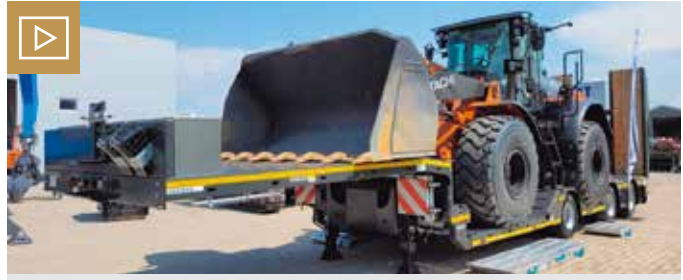
Beim STEPSTAR Satteltieflader kann die Radmuldentiefe der Bodenfreiheit der Maschine angepasst werden. Bild: Goldhofer
