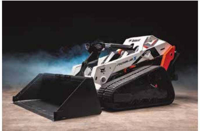
Fernsteuerbar, vollelektrisch und mit autonomen Funktionen ausgestattet: Der innovative RogueX von Bobcat befindet sich in der frühen Forschungs- und Entwicklungsphase.
