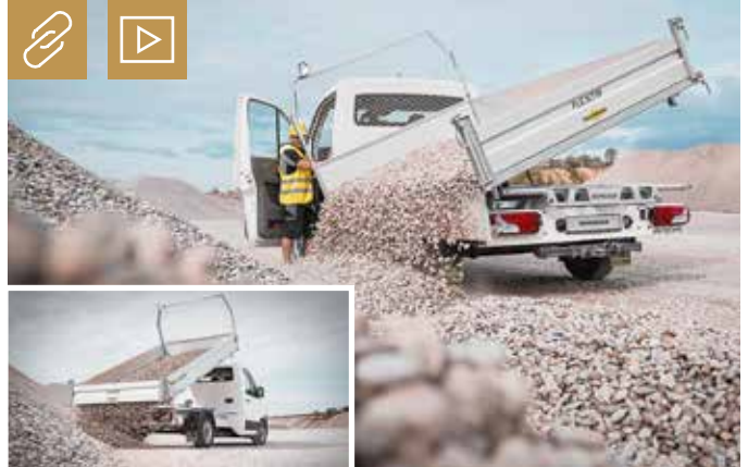
Dank der Dreiseiten-Kippfunktion gestaltet sich das Be- und Entladen beim FlexTip von Humbaur einfach. Bild: Humbaur
