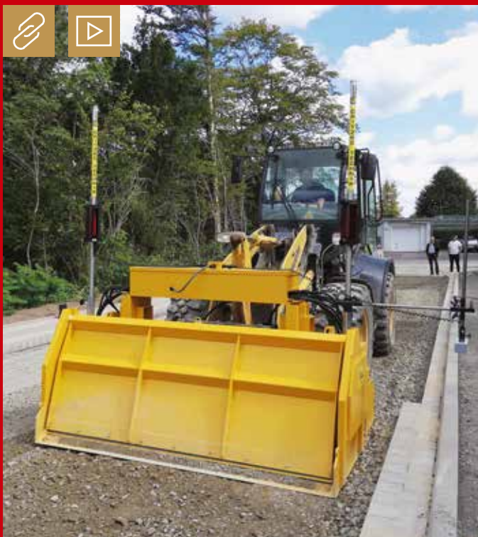
Die multifunktionalen Planiersysteme Planfix1 und Planfix2 können für verschiedene Aufgaben mit Rad-, Kompakt-, Teleskoplader oder Schlepper kombiniert werden. Bild: Gritze
