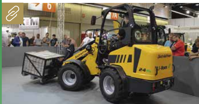
Der neue Schäffer Elektrolader 24e entspricht von außen dem erfolgreichen Modell 2445, der mit seinen 45 PS zur 0,5 m³-Klasse gehört. Bild: Paul Deder
