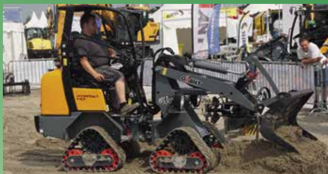
Dieser Prototyp von Tobroco-Giant baut auf der Serienmaschine D332SWT auf und bietet mehr Standsicherheit und weniger Bodendruck. Bild: Kiesel
