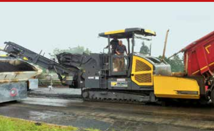
Bei der Dynapac MF2500CS wird entweder mit nur einem Förderband ein Fertiger beschickt oder ein montierbares Schwenkband erlaubt das Beschicken von zwei Fertigern. Bild: Atlas Copco
