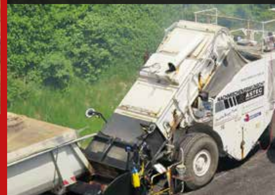
Der radmobile Nachmischbeschicker Shuttle Buggy SB-2500 von Astec puffert bis zu 22,7 t Mischgut, versorgt mit dem Schwenkband ein oder zwei Fertiger und kann bei geringer Kipphöhe wie unter Brücken zwischen Lkw und Fertiger pendeln. Bilder: Astec
