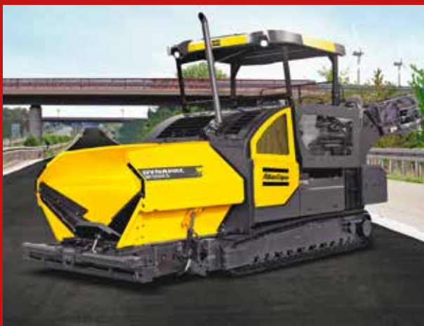
RÜKO aus Malsch ergänzte den bundesweit verfügbaren Mietpark um zwei neue, nur 2,55 m breite, ohne Genehmigungen transportierbare Dynapac MF2500CS mit bedarfsweise montierbarem Schwenkband. Bild: RÜKO
