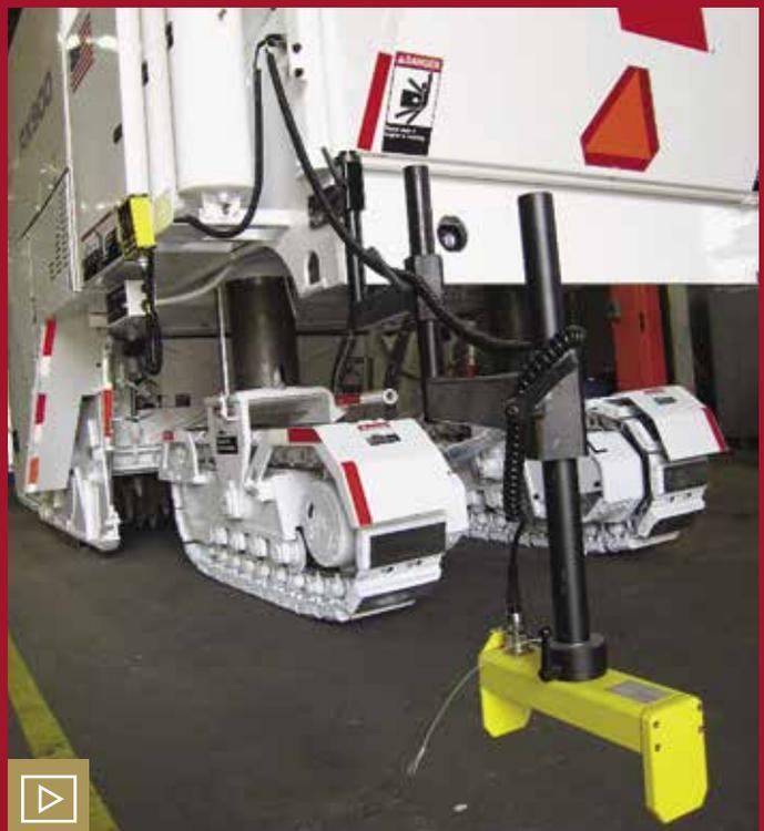
Bei der RX-900 kann der Kunde entweder drei oder vier Ketten wählen. Die Kaltfräse mit drei Ketten ist manövrierfähiger, etwas weniger wartungsintensiv und wiegt weniger. Bild: Astec
