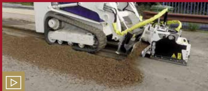
Die Simex-Anbaufräsen der PL-Serie zerfräsen das entfernte Material so sauber und fein, dass es wieder als Füllgut verwendet werden kann und teure Entsorgungskosten entfallen. **Bild: Simex**
