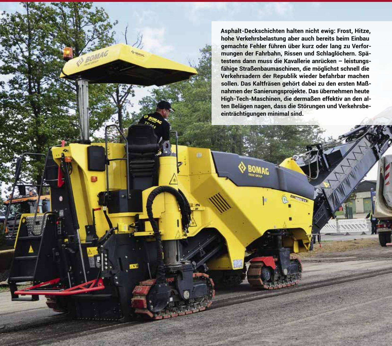
Die Bomag-Kaltfräse BM 1000/35 mit geändertem Schwenkmechanismus ist für das selektive Abfräsen von Fahrbahn- und Bodenbelägen konstruiert. Durch sehr gute Übersichtlichkeit und Wendigkeit eignet sie sich besonders für Landstraßen, innerstädtische Arbeiten sowie Kreisverkehre. Bild: Paul Deder
