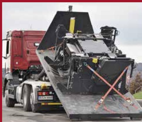
Bei Bomag können die Basismaschine und das Fräsaggregat bequem per Standard-Tief-lader und Absetzkipper zur Baustelle transportiert werden. **Bild: Bomag**
