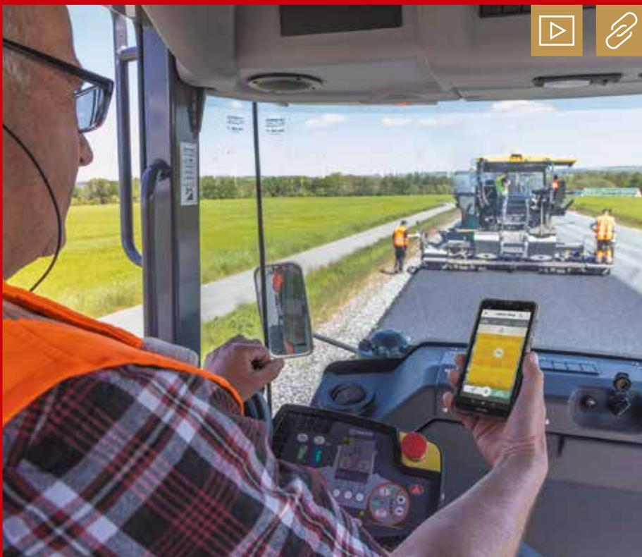
Nutzer von WITOS Paving Docu und WITOS Paving Plus, die zusätzlich das Temperatur-Messsystem RoadScan einsetzen, können mit der Jobsite Temp App alle relevanten Temperaturdaten in Echtzeit verfolgen. Bild: Wirtgen Group
