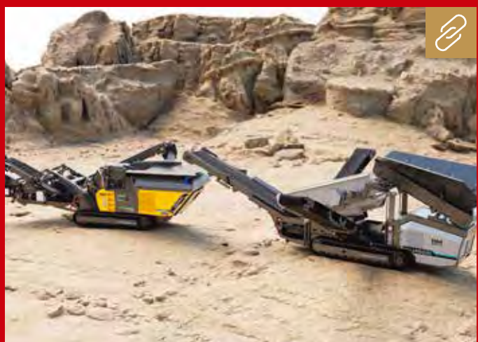
Wird das neue Hybrid-Sieb RM H50X von einem diesel-elektrischen Rubble-Master-Prallbrecher angetrieben, sparen sich die Betreiber bis zu 33 % Treibstoff. Bild: Rubble Master
