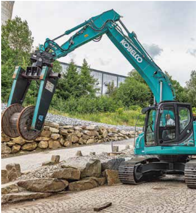
Ludwig Ellinger präsentiert mit dem Cable-Lift-Roller eine der neuesten Eigenentwicklungen von EMB. Das Anbaugerät gibt es in drei verschiedenen Größen für Bagger von 8 bis 35 t. Bilder: Paul Deder
