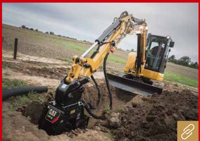
Ein hochbelastbarer Stahlrahmen und Vollgummibuchsen der Cat-Anbauverdichter liefern max. Kraft auf den Boden und minimieren gleichzeitig die Stoßwirkung auf die Maschine. Bild: Zeppelin
