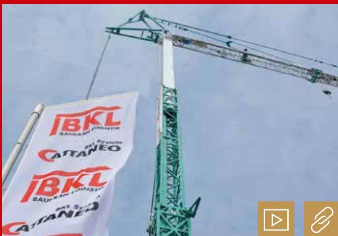
Der neueste Cattaneo-Kran von BKL ist der auf der bauma 2019 vorgestellte CM 415 mit Gitterkonstruktion, der 41 m Ausladung, 1,25 t Spitzenlast und 5 t max. Traglast bietet. Bild: BKL
