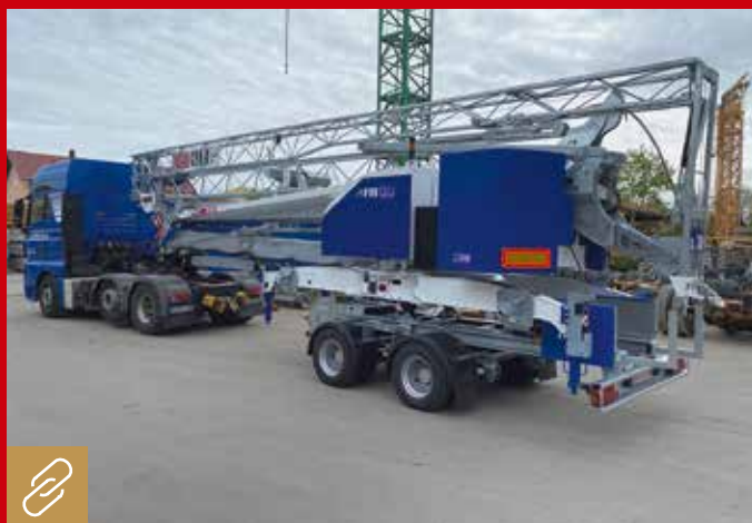
Für den FM GRU 727 RBI-FD stellen enge Baustelleneinfahrten durch seine gelenkten Achsen kein Problem dar, der Transport ist mit der 80-km/h-Tandemachse schnell und sicher zu bewältigen. Bild: Kaiser
