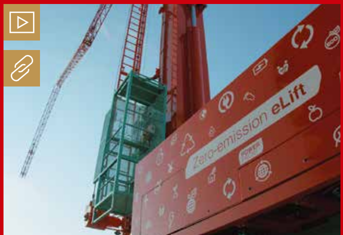
Der Ausleger des SK597-AT4 eLift bietet einen Arbeitsradius von 48 m bei einer kompakten Fahrzeuglänge. Der Kran kann seine max. Last von 7.000 kg ohne zusätzliche Ballastteile anheben. Bild: Spierings
