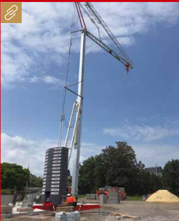
Das Steuerungssystem Easy Setup für den Aufbau der CSE-Krane von Terex ermöglicht eine exaktere Einrichtung und eine deutlich verkürzte Rüstzeit vor Ort. Bild: Terex Cranes
