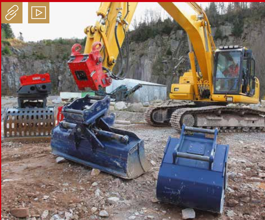
Mit dem vollhydraulischen SQ-Schnellwechsler wechseln Maschinisten aus der Kabine heraus in Sekundenschnelle zwischen Schere, Greifer, Hammer, Pulverisierer, Tief-, Sieb- oder Sortierlöffel. Bild: Lehnhoff
