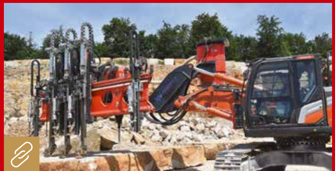
Die Jura Luna ist eine Bohranlage mit drei Bohrhämmern in einer Reihe und automatischem Spaltmechanismus. Bild: Wimmer
