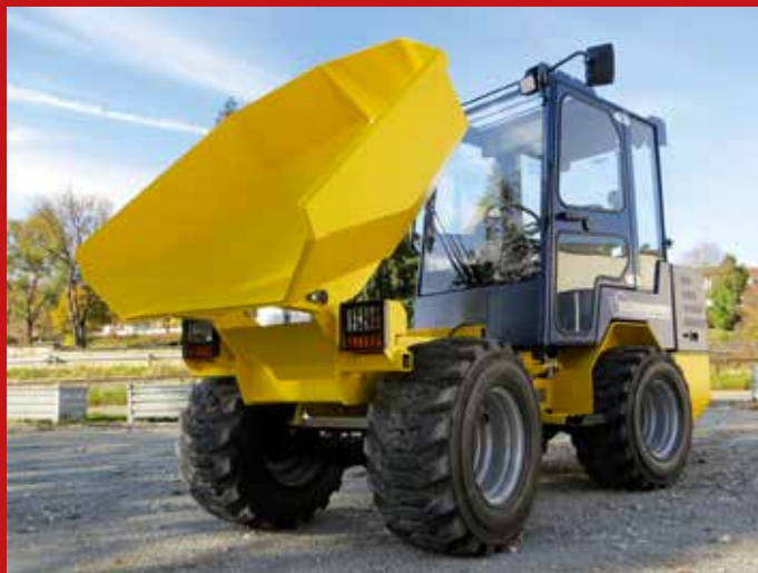
Vorprogrammierte Vielseitigkeit bietet der Bizon von Steinhauser Spezialmaschinen, der als knickgelenkter Geräteträger (Carrier) jederzeit als Radlader, Dumper und sogar als Geländestapler mit sehr hoch reichendem vertikalem Mast arbeitet. Bilder: Steinhauser Spezialmaschinen
