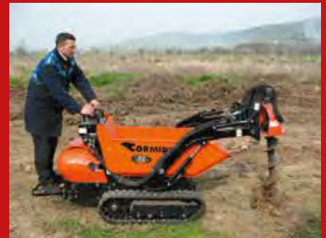
An die Schaufelhubarme der Selbstladedumper von Cormidi lassen sich Werkzeuge wie Hydraulikhammer und Erdbohrer montieren. Die größeren Modelle können anstelle der Mulde sogar Betonmischer tragen.
