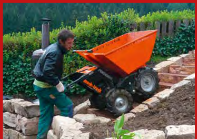
Auch Dumper wie der handgeführte MuckTruck sind Multitalente, ob mit Kupplung für schwere Palettenanhänger, Einsandbesen, Powerlifter oder diversen anderen Aufbauten. Bild: Weber Baumaschinen
