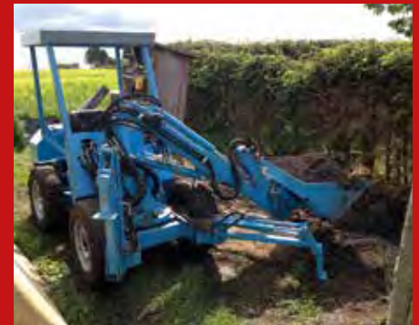
Motag-Lader lassen sich mit Motoren von 8 bis 35 kW und einer Zusatzhydraulik mit unterschiedlicher Leistung ausstatten und fungieren als Schwenklader, Geländestapler, Tieföffel- oder Greifbagger, und dies stets sicher abgestützt. Bilder: Motag
