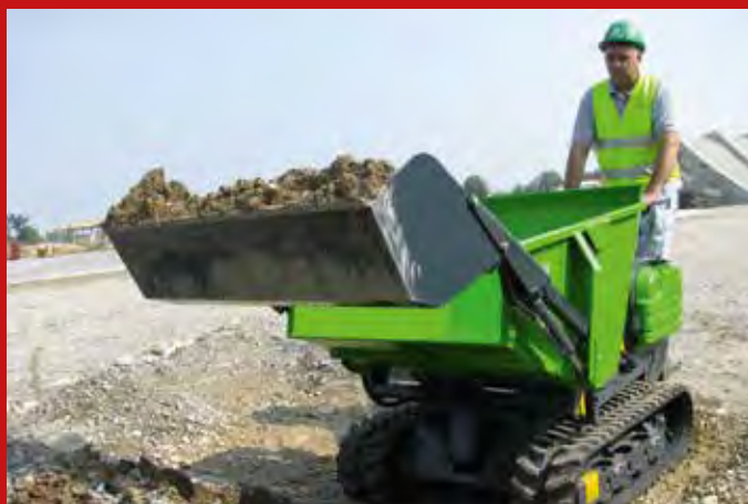
Die handgeführten Cingo von Merlo sind vielseitige Ausrüstungsträger, ob im Winterdienst, als Raupenlader mit Teleskoparm, mit Mulcher, Palettenhalter oder Betonmischer. Bilder: Merlo
