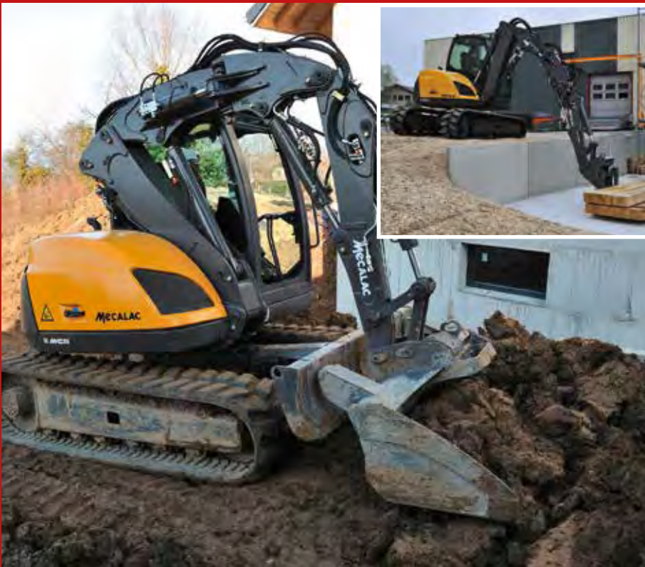
Der Mecalac 8MCR reicht besser als jeder Stapler unter sein Standniveau; beim Einsatz als Raupenlader stützt sich die Schaufel am Schild ab und belastet so nicht den Ausleger. Bilder: Mecalac
