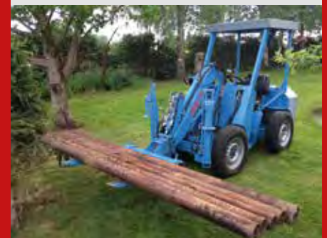
Motag-Lader lassen sich mit Motoren von 8 bis 35 kW und einer Zusatzhydraulik mit unterschiedlicher Leistung ausstatten und fungieren als Schwenklader, Geländestapler, Tieföffel- oder Greifbagger, und dies stets sicher abgestützt. Bilder: Motag
