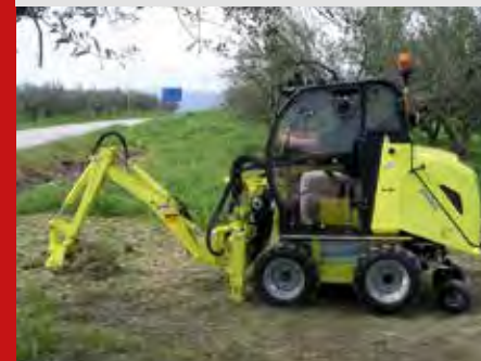
Extrem vielseitig ist der nur 1,22 m breite, einarmige MDB Jumbo. Anzubauen sind u. a. Frontbagger, Vorbau-Stapler, Glättwalze, Seitenmäher, Schneefräse oder Stützräder- Traverse. Bilder: MDB
