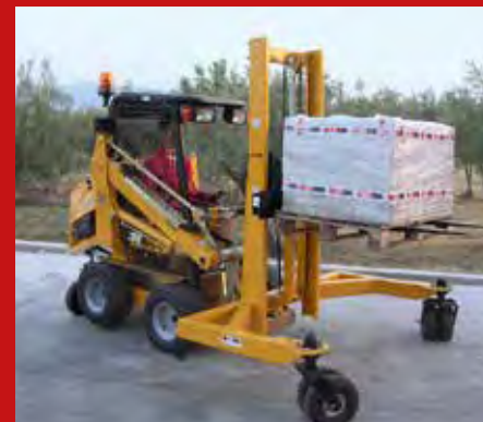
Extrem vielseitig ist der nur 1,22 m breite, einarmige MDB Jumbo. Anzubauen sind u. a. Frontbagger, Vorbau-Stapler, Glättwalze, Seitenmäher, Schneefräse oder Stützräder- Traverse. Bilder: MDB
