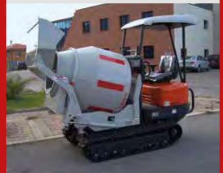
An die Schaufelhubarme der Selbstladedumper von Cormidi lassen sich Werkzeuge wie Hydraulikhammer und Erdbohrer montieren. Die größeren Modelle können anstelle der Mulde sogar Betonmischer tragen.
