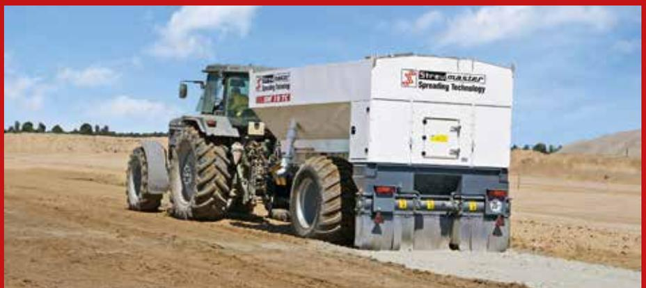
Ob für Frontanbau – bei frei bleibendem Traktorheck für eine Anbaufräse – oder als Anhänger, Wirtgen bietet ein breites Programm von Streumaster-Geräten zum effizienten Aufbringen von Bindemitteln für die Bodenstabilisierung. Bild: Wirtgen
