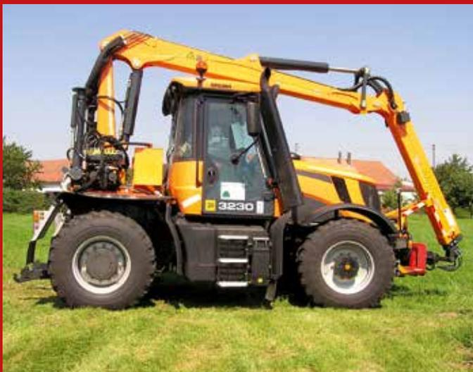
Die Traktoren der Fastrac-Baureihe von JCB mit 168 bis 272 PS Leistung lassen sich vielseitig ausrüsten, hier mit einem Lkw-Ladekran, und ziehen sogar mit bis zu 70 km/h Tempo einen Tieflade-Anhänger auf der Autobahn.
