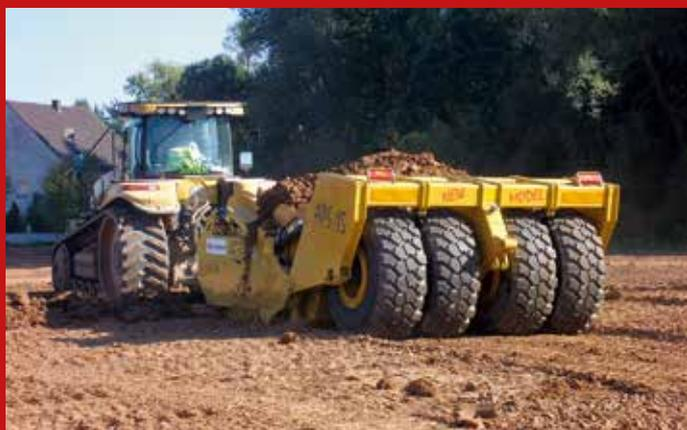
Die AP-Scrapper im Vertrieb von Wansor, hier von einem Challenger-Raupentraktor gezogen, transportieren große Massen, bauen sie während der Fahrt ein und lassen sich mit Maschinensteuerungen von Topcon ausrüsten.
