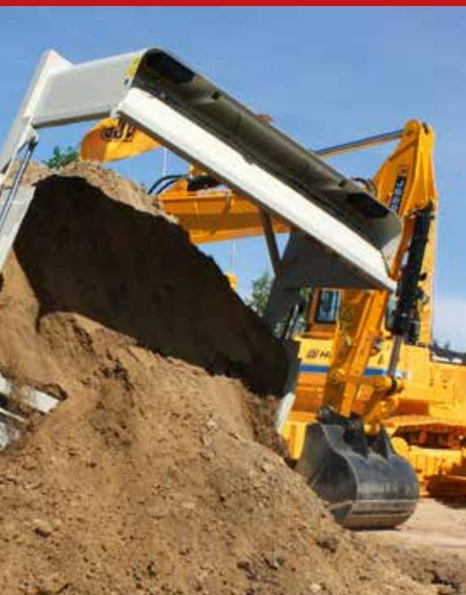
Sogar stark schräg stehend entleeren die ASW Stone-Anhänger von Fliegl dank patentierter Abschiebeteknik ihre 16 bis 19 m<sup>3</sup> Ladung sicher und bei Bedarf auch dosiert während der Fahrt; zulässig sind 22 bis 31 t Gesamtgewicht. Bild: Fliegl
