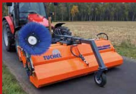
Die für Traktoren konzipierte Tuchel-Kehrschnecke Maxi mit 2,4 oder 2,8 m Arbeitsbreite besitzt hydraulische Seitenverstellung, 3. Stützrad zur gleichmäßigen Bodenführung und eine Wassersprüheinrichtung zur Staubbinderung mit 200-l-Tank. **Bild: Tuchel**
