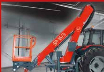
Die hydraulische Teleskop-Hubbühne SR-16/3 von BVT wurde eigens für den Heckanbau an Traktoren konzipiert, faltet sich zur Fahrt eng zusammen, reicht 9 m weit und erzielt fast 16 m Arbeitshöhe.
