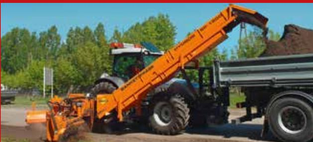
Mit hohem Wirkungsgrad von der Zapfwelle angetrieben wird die Hydrog-Bankettfräse SP-1200 für 0,5 bis 1,2 m Arbeitsbreite, bestimmt zum Heckanbau an Traktoren mit über 110 PS Leistung und einem Kriechgang für unter 350 m/h Vortrieb. Bild: Hydrog
