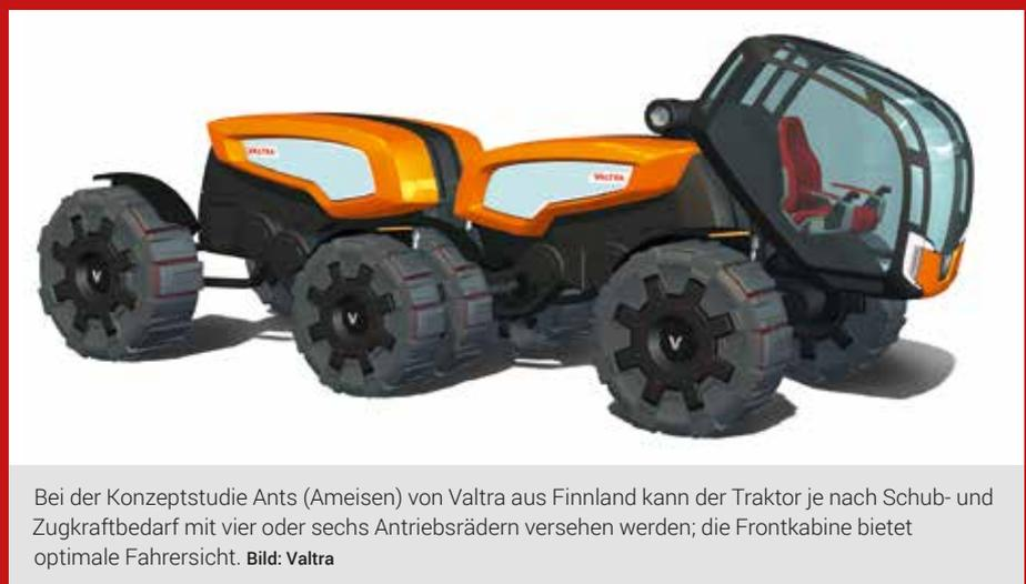
Bei der Konzeptstudie Ants (Ameisen) von **Valtra** aus Finnland kann der Traktor je nach Schub- und Zugkraftbedarf mit vier oder sechs Antriebsrädern versehen werden; die Frontkabine bietet optimale Fahrersicht. **Bild: Valtra**
