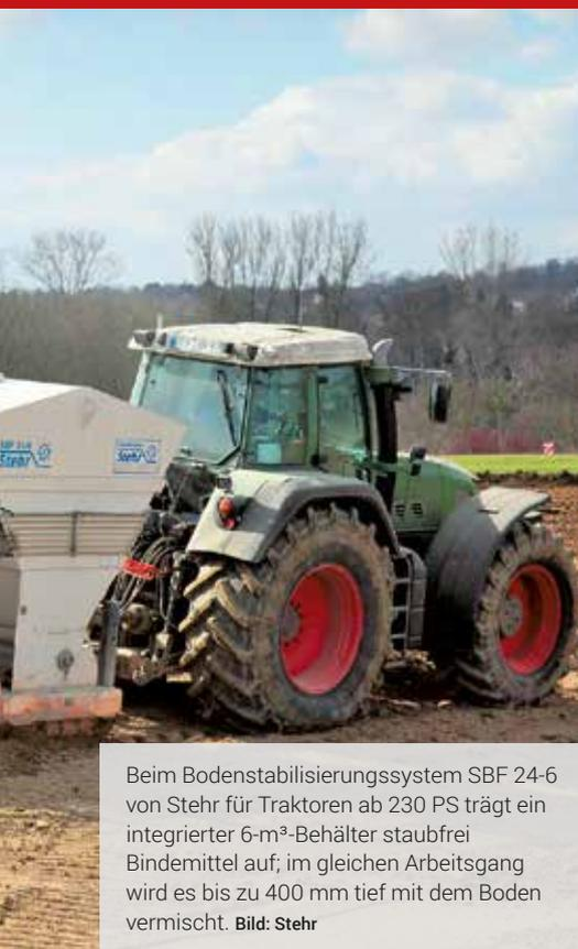
Beim Bodenstabilisierungssystem SBF 24-6 von **Stehr** für Traktoren ab 230 PS trägt ein integrierter 6-m<sup>3</sup>-Behälter staubfrei Bindemittel auf; im gleichen Arbeitsgang wird es bis zu 400 mm tief mit dem Boden vermischt. **Bild: Stehr**
