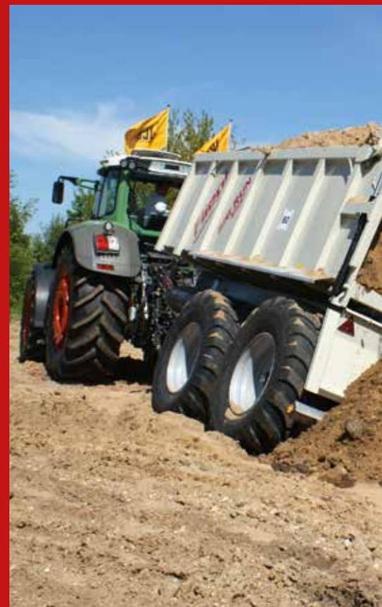
Robuste Muldenanhänger wie der Krampe-Halfpipe HP30 für bis zu 30 t Nutzlast ersetzen Muldenkipper, fahren aber wie Lkw auch auf Straßen; wichtig sind große Muldenlänge für das problemlose Beladen mit Radladern und auch über das Heck mit Baggern. **Bilder: Krampe**
