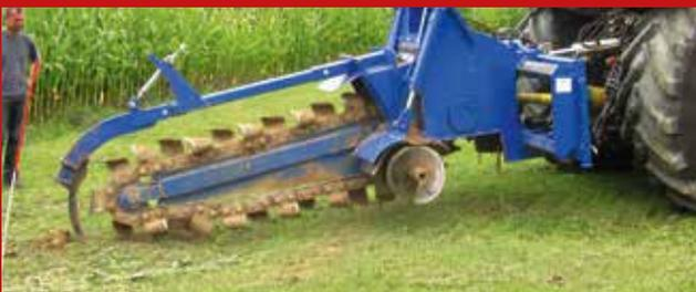
Die Anbau-Grabenfräse GMA 160 von LIBA wird nicht hydraulisch, sondern direkt von der Traktor-Zapfwelle angetrieben und kann wahlweise mit Förderband, Verfüllschnecke und Laserführung ausgestattet werden. Bild: LIBA
