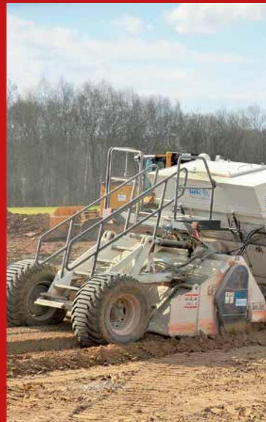
Ob beim Bodenstabilisieren, Brechen von Asphalt oder im Wegebau, die Anbaufräsen von Kamps Seppi lassen sich mit Zubehör wie hydraulischer Walze, Kufen mit seitlicher Materialzuführung oder auch einstellbarem Planierschild ausstatten.
