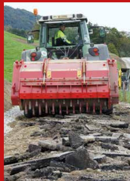
Der Anbau-Steinbrecher Seppi Maxisoil für 300 bis 450 PS starke Traktoren fräst max. 35 cm tief, zerkleinert bis zu 50 cm große Steine und kann daher auch im Kaltrecycling effizient Straßenaufbruch einbaugerecht zerkleinern. **Bild: Kamps Seppi M.**
