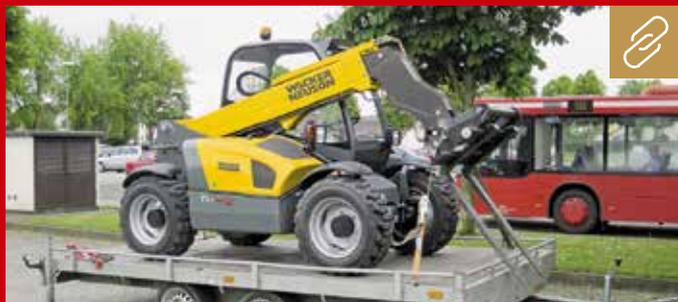
Kompakte Teleskoplader wie dieser TH412 von Wacker lassen sich relativ einfach per Anhänger zur Baustelle bringen. Ein Flurfördermittelerscheinung ist für die Bedienung dieser Maschinen nicht nötig. **Bild: Wacker**
