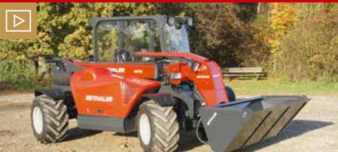
Der Thaler-Teleskoplader 48T18 gehört zur Kategorie der Mini-Teleskoplader und vereint alle Vorteile der Teleskop-Modelle bei kompakten Außenmaßen. **Bild: Thaler**
