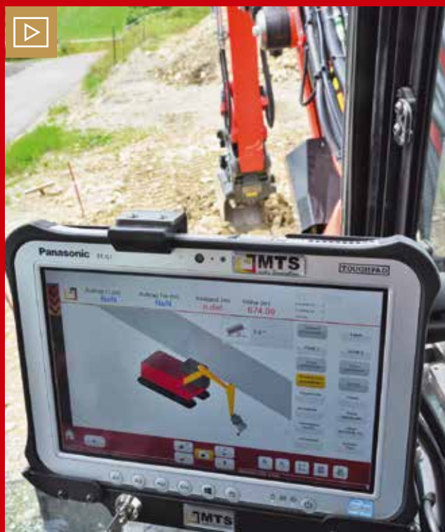
Das MTS-NAVI ist das Kernstück von MTS-PILOT und erlaubt dem Geräteführer, via Satellit und Neigungssensoren seinen Baggerlöffel entlang eines digitalen Geländemodells zu navigieren. Bild: Paul Deder
