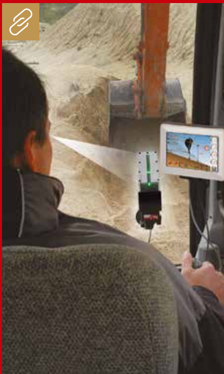
Bei iDig wird die aktuelle Lage der Löffelschneide dem Fahrer in Echtzeit (numerisch und per LED-Lichtleiste) kontinuierlich angezeigt. Bild: Bridgin
