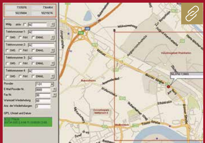
Das Telematiksystem Maco 1400 T überwacht den Bewegungsradius einer Maschine durch Geofencing. Verlässt eine Baumaschine ein zuvor definiertes Territorium, erfolgt eine Alarmpmeldung. Bild: Baumaco
