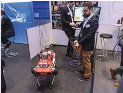
Bei ANYbotics, einem Spin-Off der ETH Zürich, werden autonome Laufroboter für Inspektions- und Vermessungsaufgaben entwickelt. Bild: Paul Deder
