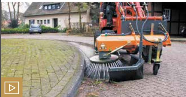
ler, Minibagger, Frontmäher oder Kompaktschlepper, der Groby light kann hydraulisch über einen starken Gerotormotor oder optional mechanisch über Zapfwelle angetrieben werden. Mit dem PowerPack von Bema können zudem Trägerfahrzeuge den Groby light nutzen, denen ausreichende Hydraulikleistung am Anbau fehlt.
