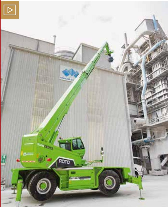
Das Modell MRT 2470 der Privilege-Plus-Baureihe von Manitou bietet 129 kW (176 PS), 7.000 kg Tragkraft und eine Hubhöhe von bis zu 24,8 m. Bild: Manitou
