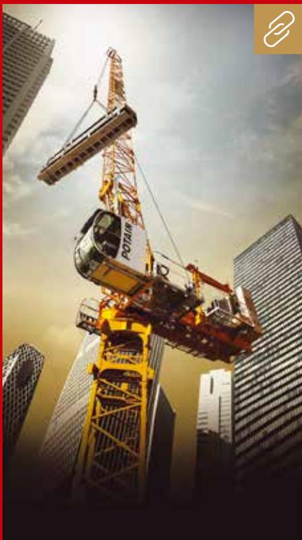
Die MRH-Reihe kombiniert die Vorteile der Potain MR-Turmdrehkrane mit Wipper und der MDT Topless-Krane. Bild: Manitowoc
