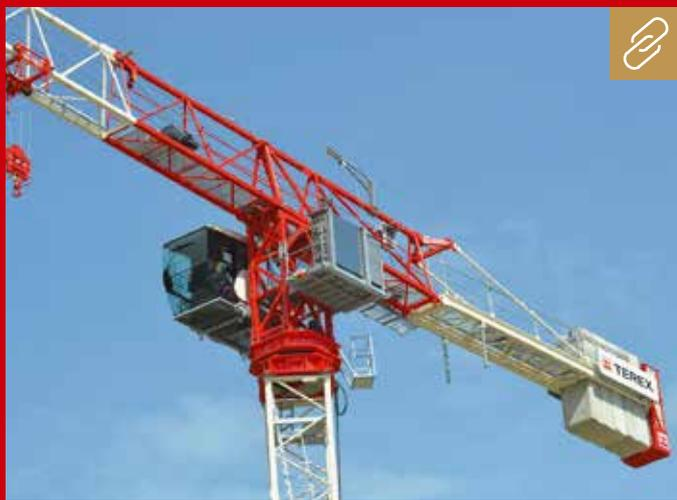
Die „Power Plus“-Funktion ermöglicht dem Terex CTT 202-10-Kran unter bestimmten und kontrollierten Bedingungen eine kurzzeitige Erhöhung des max. Lastmoments um 10 %. Bild: Terex
