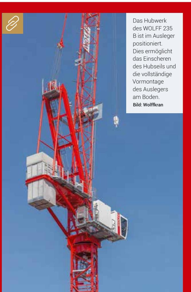
Das Hubwerk des WOLFF 235 B ist im Ausleger positioniert. Dies ermöglicht das Einscheren des Hubseils und die vollständige Vormontage des Auslegers am Boden.
