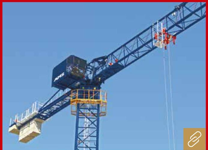
Die neue Generation der AK-Turmdrehkran-Reihe von AMS Kranbau zeichnet sich durch eine neue Fahrerkabine sowie überarbeitete Steuerungstechniken der Dreh-, Katzfahr- und Hubwerke aus. Bild: AMS
