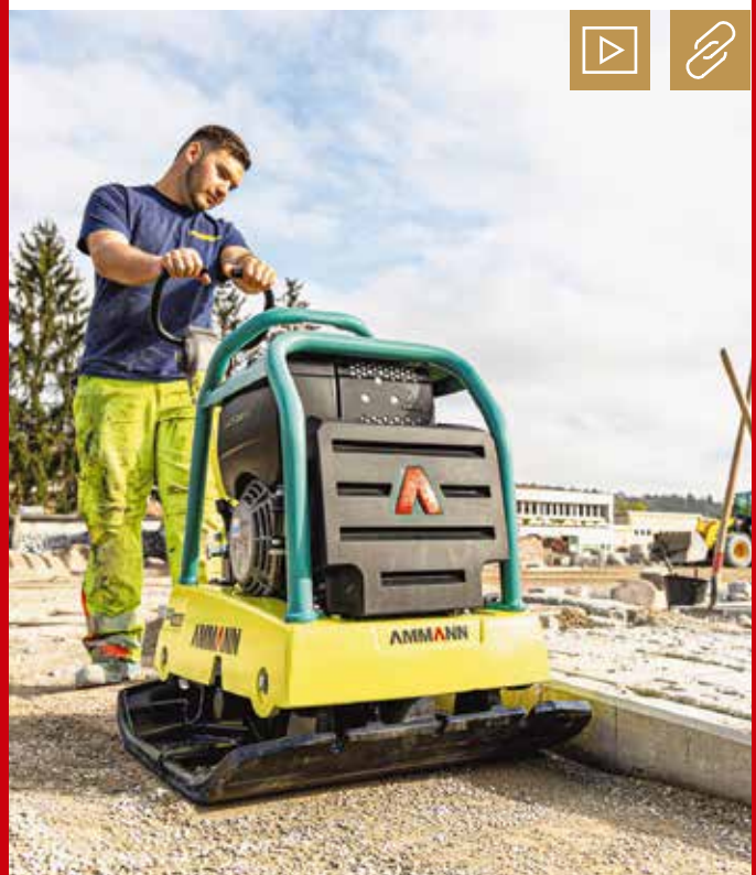
Trotz eines Maschinengewichtes von 263 kg bzw. 269 für die Diesel-Variante ist die Rüttelplatte APR 40/60 leichtgängig und lässt sich dank hydrostatischer Steuerung präzise führen. Bild: Ammann
