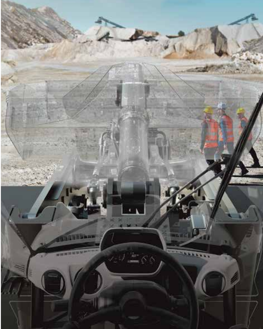
Bei der „transparenten“ Schaufel handelt es sich um das erste Sicherheitssystem seiner Art, das eine Lösung zur Verhinderung von Unfallgefahren aufgrund des toten Winkels vor der Schaufel von Radladern bietet. Bild: Doosan
